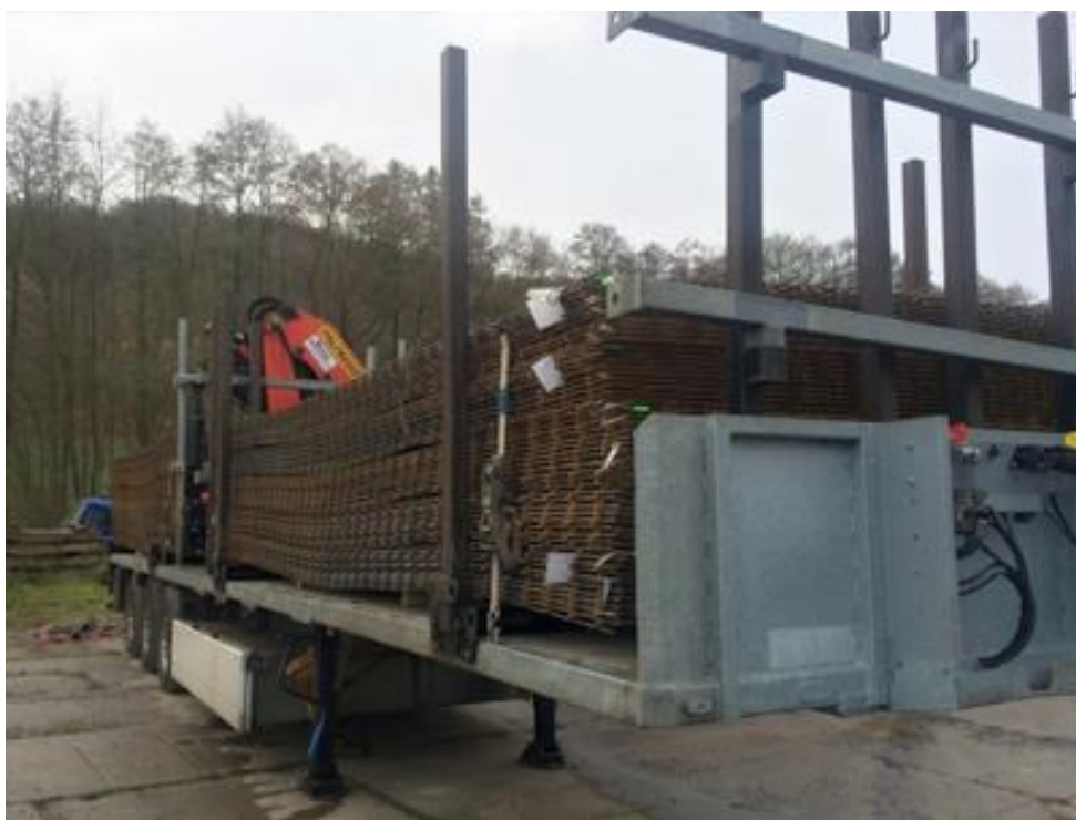
Obr. 3.3 Přeprava betonářské oceli. Zdroj: [12]
