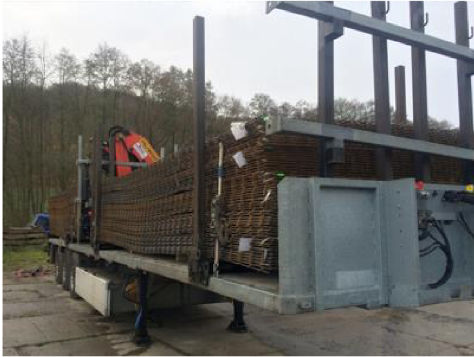
Obr. 3.3 Přeprava betonářské oceli. Zdroj: [12]
