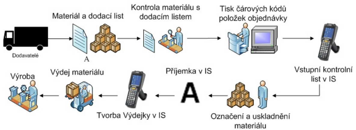
Obr. č. 27: Průběh ve skladu s využitím čárových kódů (Zdroj: vlastní zpracování)
