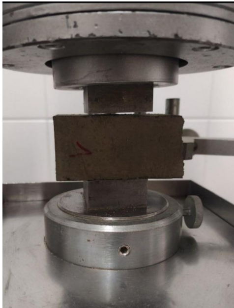
Obr. 12: Detail měřicí hlavy pro zkoušku pevnosti v tlaku.
