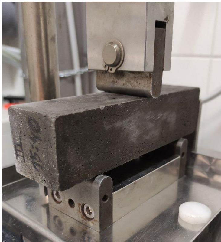
Obr. 11: Detail měřicí hlavy pro zkoušku pevnosti v tahu za ohybu.
