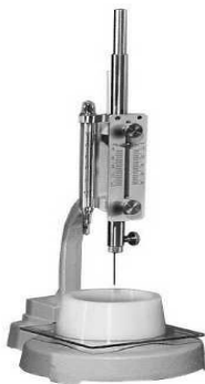
Obr. 13: Vicatův přístroj s prstencem [52].
