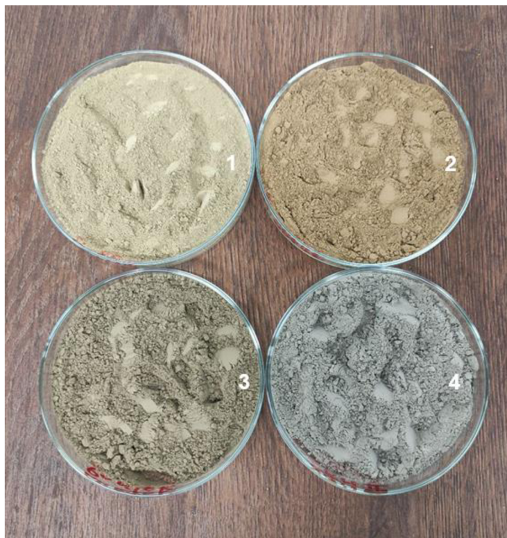
Obr. 19: Připravené experimentální cementy s vápencem (1), cihlovým obrusem (2), popílkem (3) a referenční cement CEM II /B-M (V-LL) 32,5 R (4)
