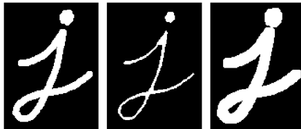
Obr. 3.1: Ukážka pôvodného obrázku (vľavo), obrázku po erózii (v strede) a obrázku po dilatácii (vpravo) 1
