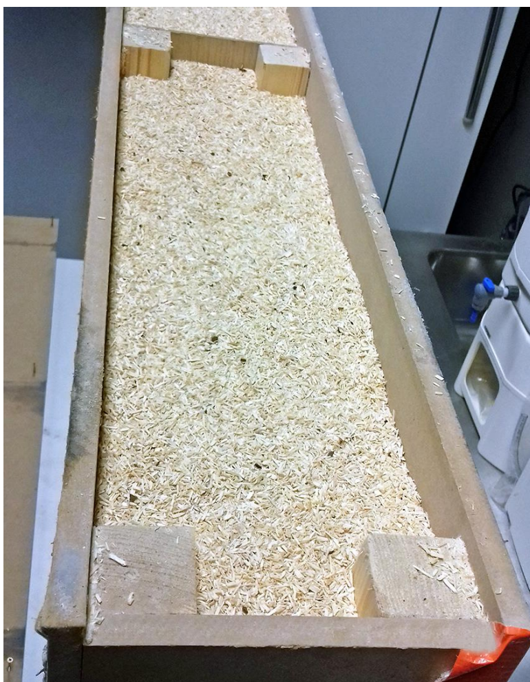
Příloha 18: Panel na bázi dřeva s izolační výplní z dřevní štěpky (ozn. 3)
