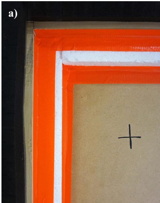
Příloha 5: (a) Instalace izolačního rámečku z expandovaného polystyrenu po obvodu panelu, (b) instalace teplotního čidla pomocí tmelu a lepicí pásky
