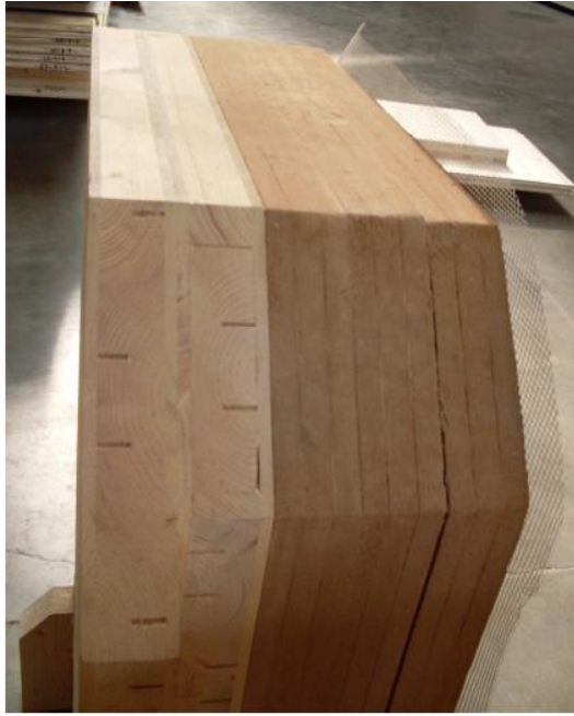
Obrázek 8: Příklad panelu z křížem lepeného lamelového dřeva s kontaktní dřevovláknitou izolací (Hudec, 2013)
