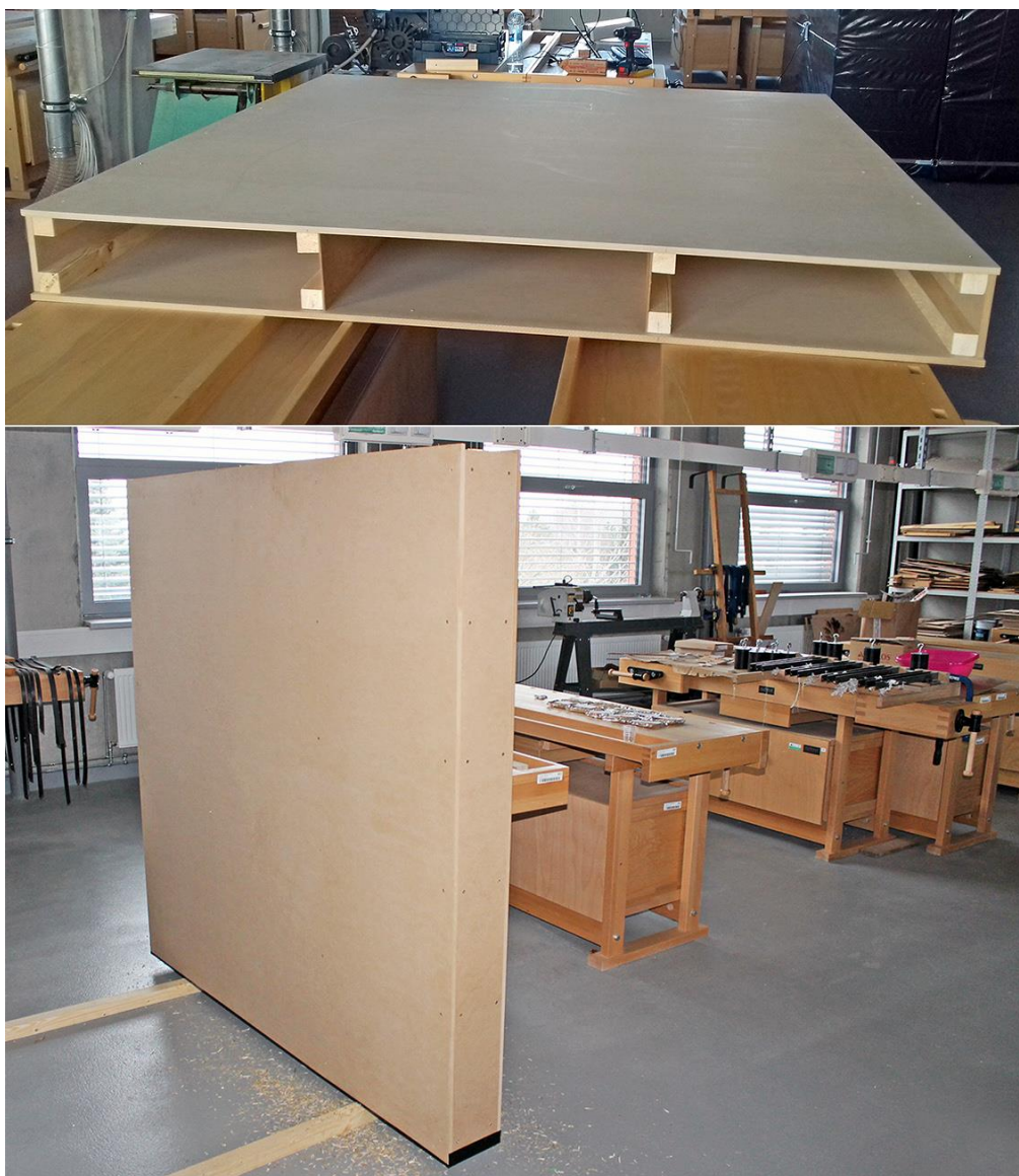
Příloha 13: Výroba konstrukce panelu na bázi dřeva pro testování izolačních výplní (ozn. 1-4) ve fakultní dílně
