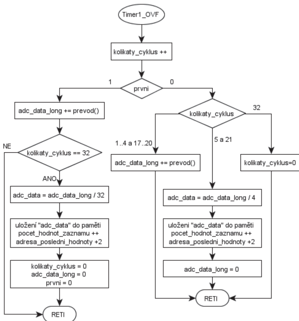
Obrázek 3.3: Vývojový diagram, obsluha přerušeni od časovače/čítače 1.
