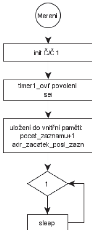
Obrázek 3.2: Vývojový diagram, hlavní program, měřící část.
