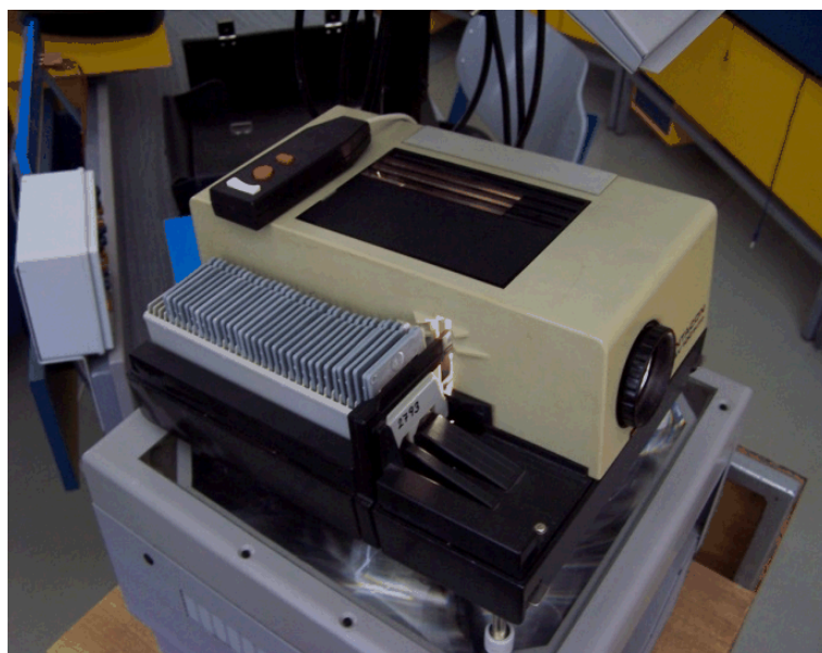
Obr. 8b. Vzhled diaprojektoru Pentacon s vloženým zásobníkem a dálkovým ovladačem (foto autor)
