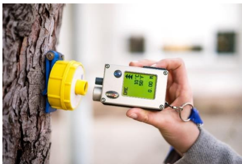
Obrázok 3 Elektronický výškomer VERTEX, ultrazvuková odrazka. Zdroj: Tibor Ďuriš.
