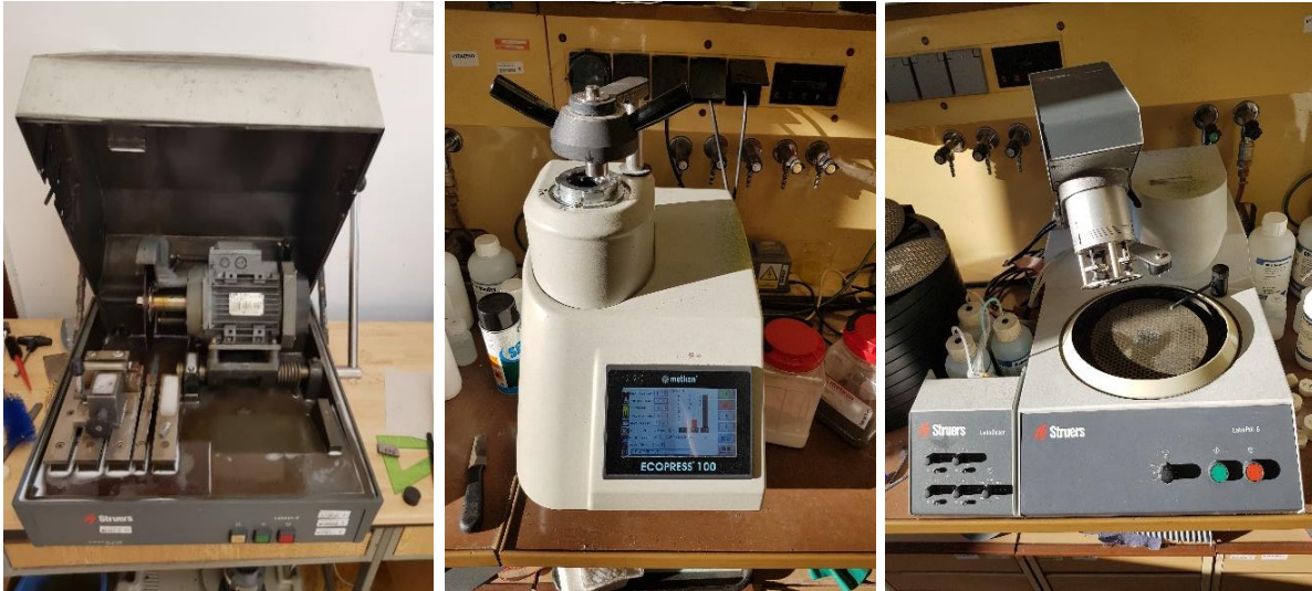
Obr. 43 Přístroje pro přípravu vzorků: vlevo: kotoučová pila Struers s chlazením, uprostřed: lis na vzorky Metkon ECOPRESS 100, vpravo: brousící zařízení Struers LaboPol-5.
