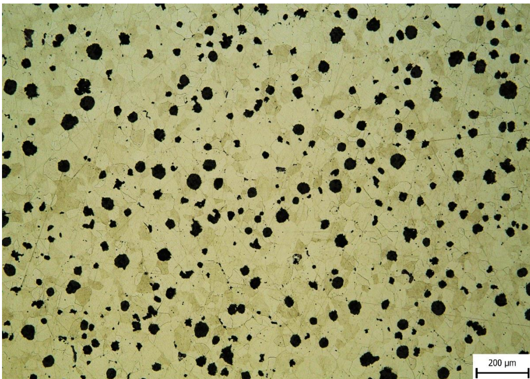
Obr. 53 Metalografický výbrus: tavba 679 – po TZ, blok 50, leptáno (nital 3%).
