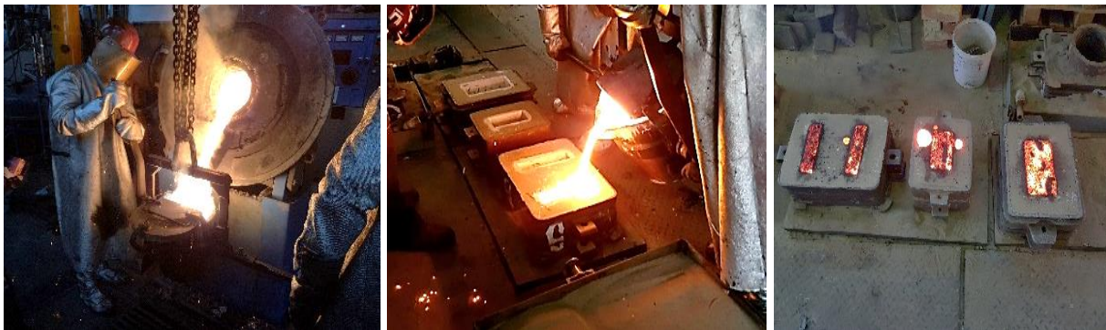
Obr. 30 Průběh 2. tavby (679) ve slévárně VUT v Brně: obrázek vlevo: odpich kovu a modifikační reakce, obrázek uprostřed: odlévání, obrázek vpravo: odlité Y-bloky s exozásypem.
