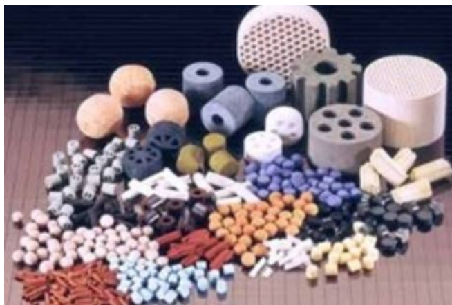
Obrázek 5.3: Typy výplní sypaných loží. Převzato z [24].
