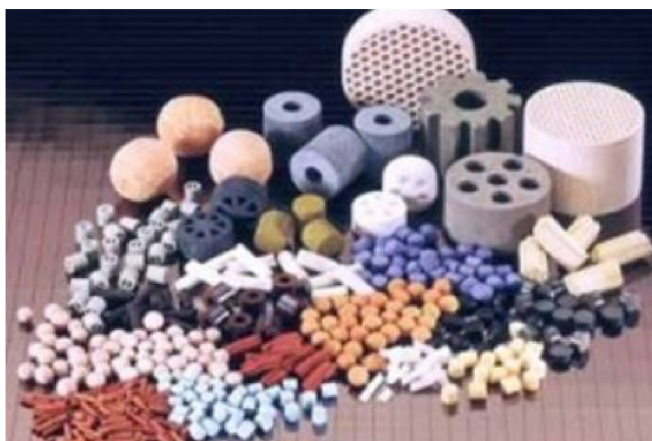
Obrázek 5.3: Typy výplní sypaných loží. Převzato z [24].
