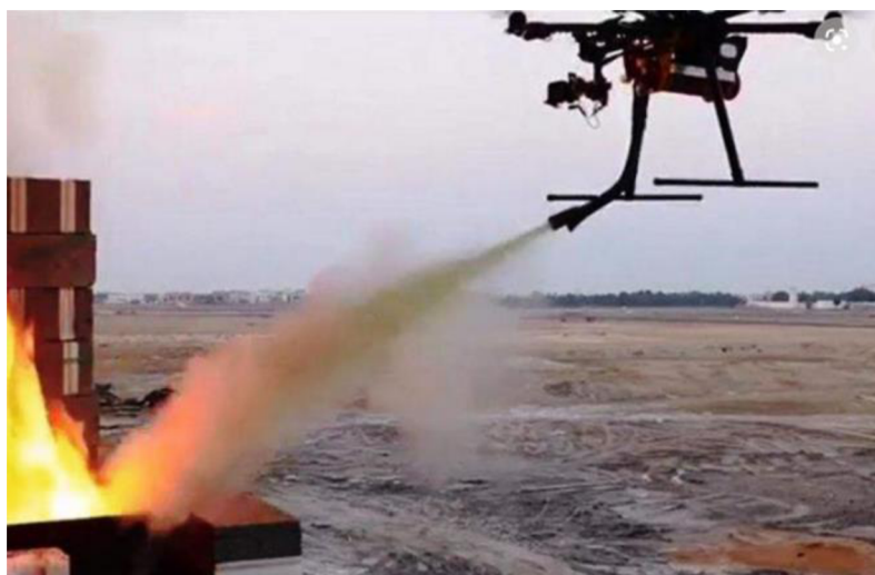
Obrázek 19 - Hašení s tlakovou lahví
