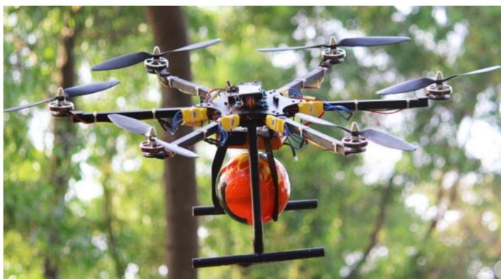
Obrázek 9 - Hasičský dron s požární koulí
