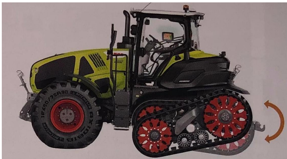
Obrázek 52: Naklonění a vyklonění pásové jednotky TerraTrac [59]
