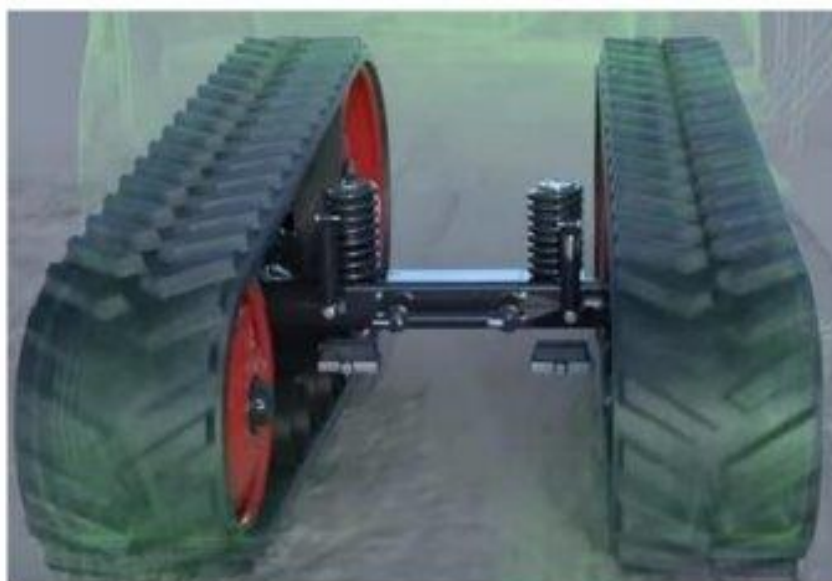
Obrázek 20: Odpružení pásového podvozku Fendt MT [16]
