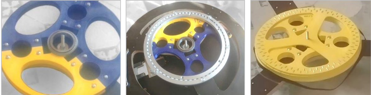
Obr. 13: a) Původní malé kuželíkové ložisko, b) nahrazeno nejprve 12palcovým kuličkovým axiálním ložiskem lazy susanne, a následně nahrazeno c) válečkovým axiálním ložiskem vlastní konstrukce.
