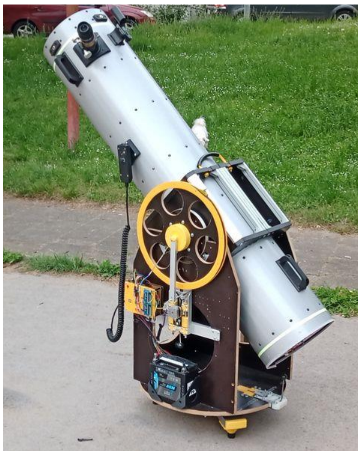
Obr. 38: Dalekohled vystrojený upraveným pohonem
