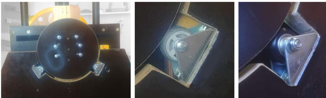
Obr. 14: a) Uložení osy Alt na kolečkách – celkový pohled, b) Původní kolečka s pogumovaným povrchem.. c) nahrazena kolečky s pevným povrchem
