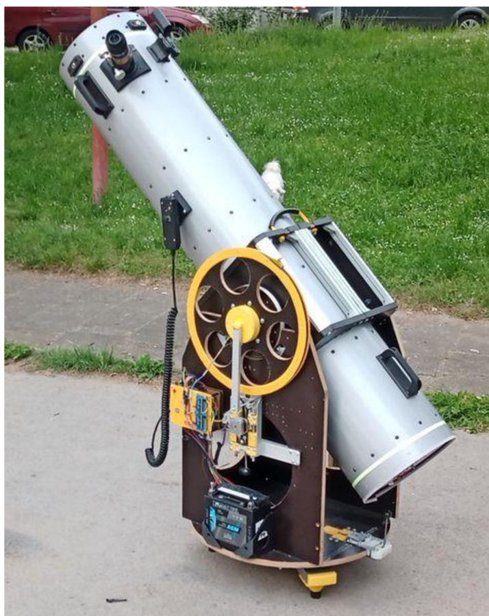
Obr. 38: Dalekohled vystrojený upraveným pohonem
