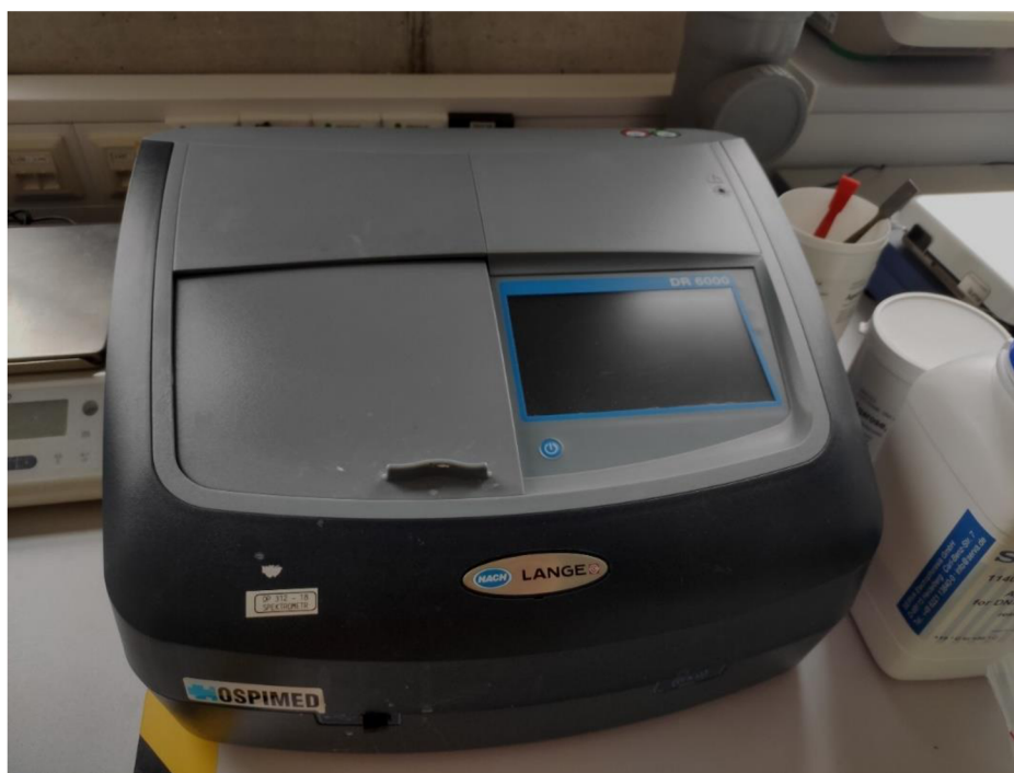
Obrázek 13 – Spektrofotometr DR 6000 (Řehořová 2022)
