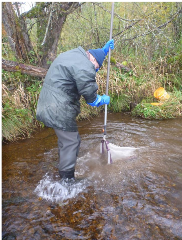
Obrázek 1 - Zobrazení způsobu odběru substrátu s bentosem "kikáním" (metoda kick sampling), říjen 2020, autor: Stefanie Audyová
