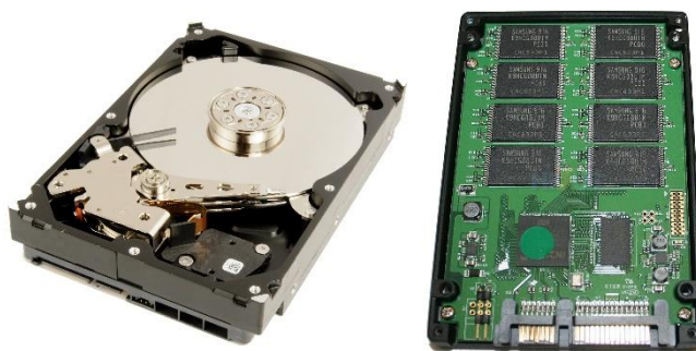
Obr. 24: Rozebraný pevný disk a rozebrané SSD
