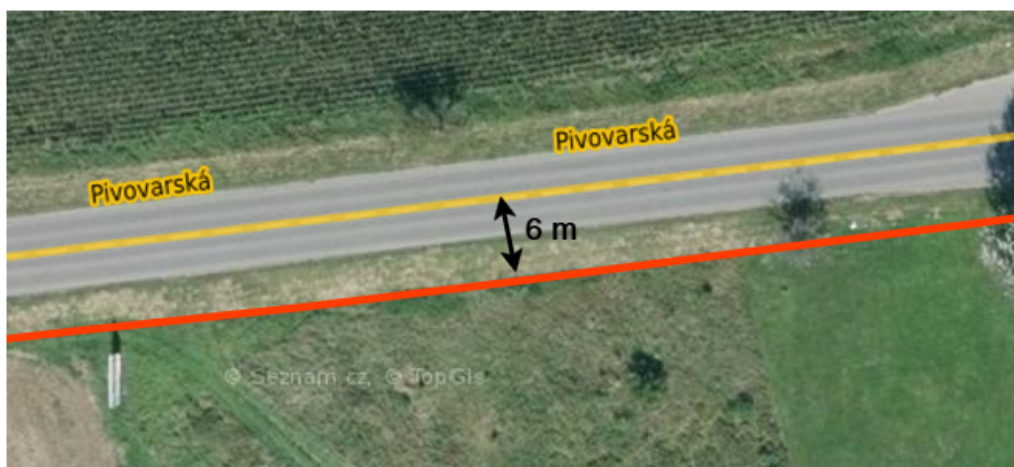
Obrázek 5.3: Maximální odchylka určení polohy při testování v autě. Vizualizováno pomocí webové služby Mapy.cz.
