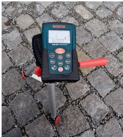
Obrázek 2 Laserový dálkoměr Bosh GLE 40 Professional použitý pro měření
