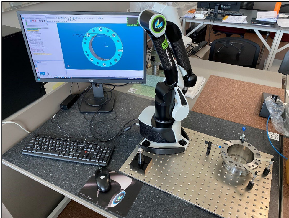
Obr. 34 Vybavenie použité k meraniu etalónu v laboratóriu UVSSR [foto: autor]
