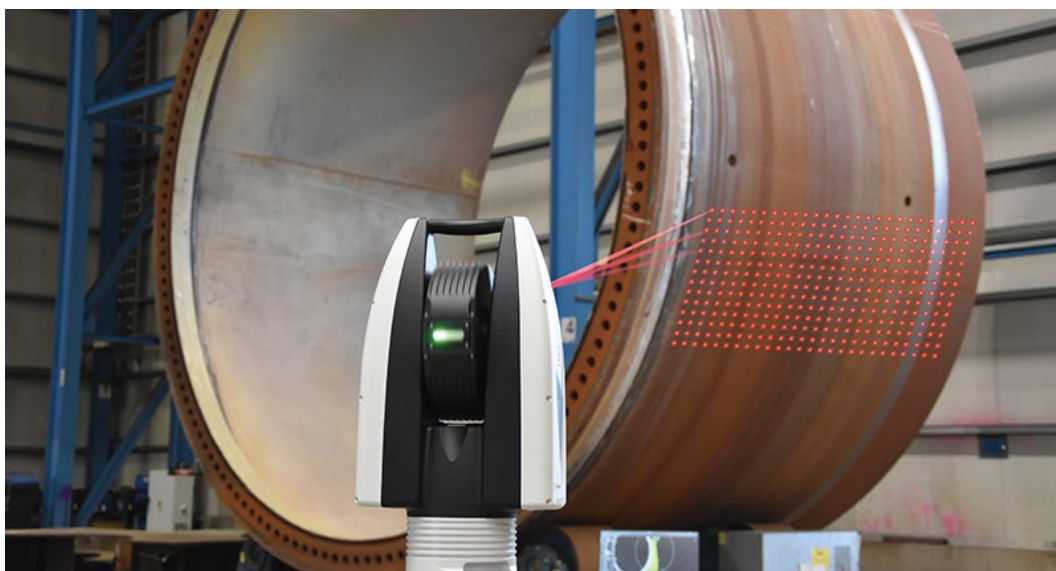
Obr. 9 Leica Absolute Tracker ATS600 umožňuje vykonávať laserové merania bez laserových terčov, priamo z laserového systému snímacieho zariadenia. [5]
