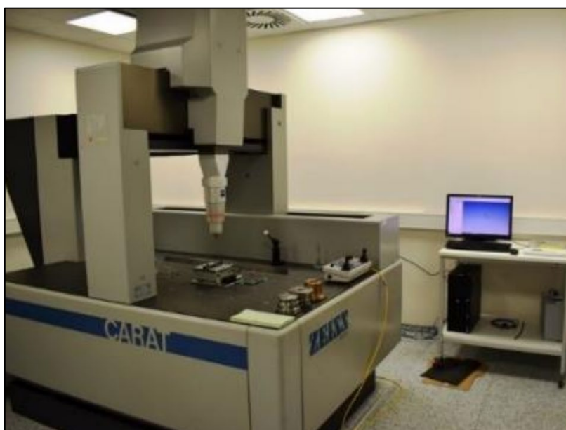
Obr. 31 CMM Zeiss UPMC 850 Carat v laboratóriu ČMI [31]
