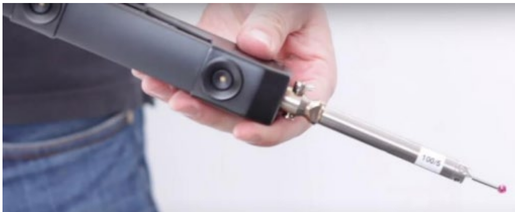
Obr. 12 Sonda pre meranie hlbokých úzkych dier (Metronor) [16]
