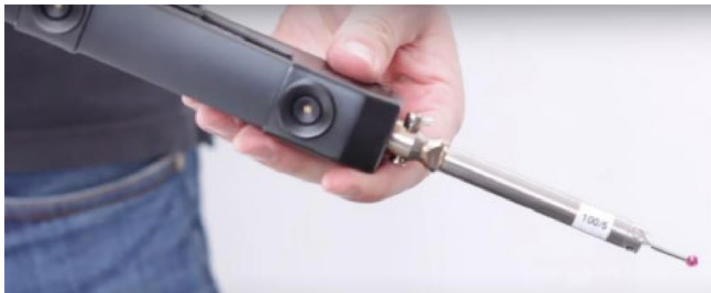
Obr. 12 Sonda pre meranie hlbokých úzkych dier (Metronor) [16]
