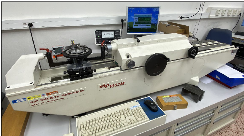
Obr. 29 Digitálny jednoosí dotykový dĺžkomer SIP 1002M v laboratóriu ČMI [foto: autor]
