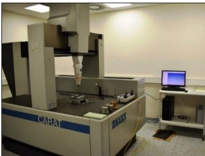
Obr. 31 CMM Zeiss UPMC 850 Carat v laboratóriu ČMI [31]
