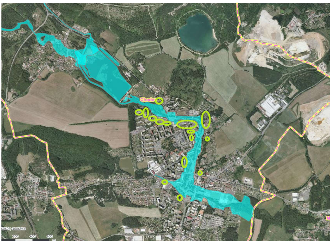
Obr. 25 záplavové území Q100 Chodovský potok s naznačením zvýšení vegetace v rámci modrozelené infrastruktury
