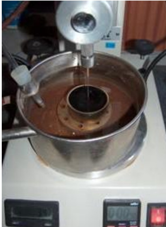
Obrázok č. 46: Penetrácia ihlou do vytemperovaného vzorku [41]
