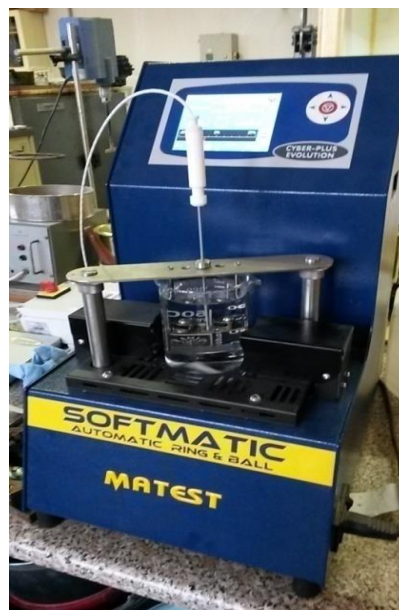
Obrázok č. 48: Prístroj pre skúšku stanovenie bodu mäknutia metódou KK
