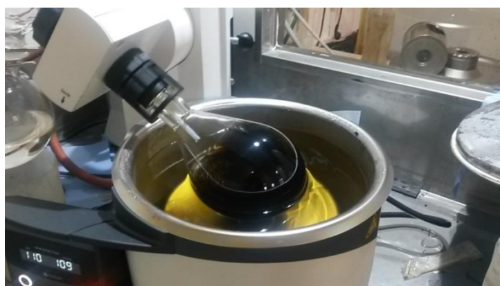
Obrázok č. 40: Zmes asfaltového spojiva a rozpúšťadla v banke v olejovom kúpeli
