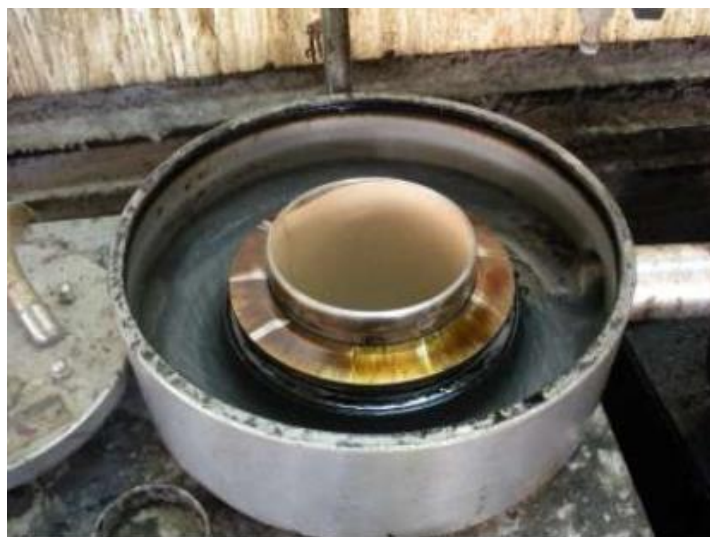
Obrázok č. 36: Umiestnenie patróny s filtračným papierom [35]
