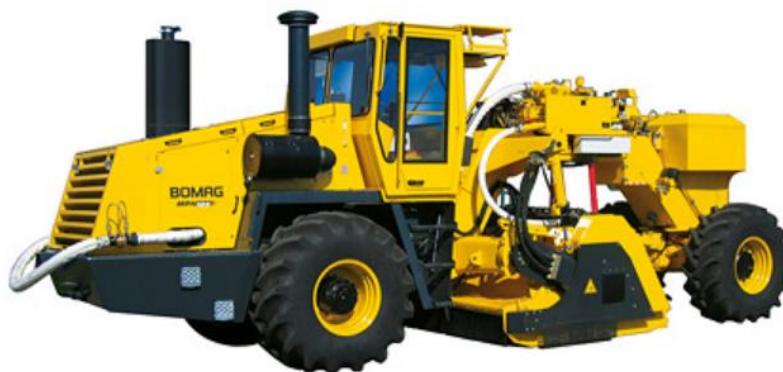
Obrázok č. 2: Recyklačná fréza Bomag [6]
