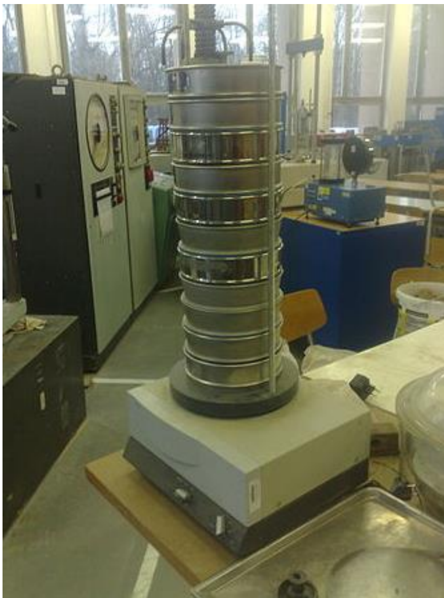
Obrázok č. 41: Prístroj na vibračné preosievanie kameniva [37]
