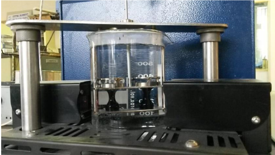
Obrázok č. 49: Prepad guľôčok asfaltovým spojivom
