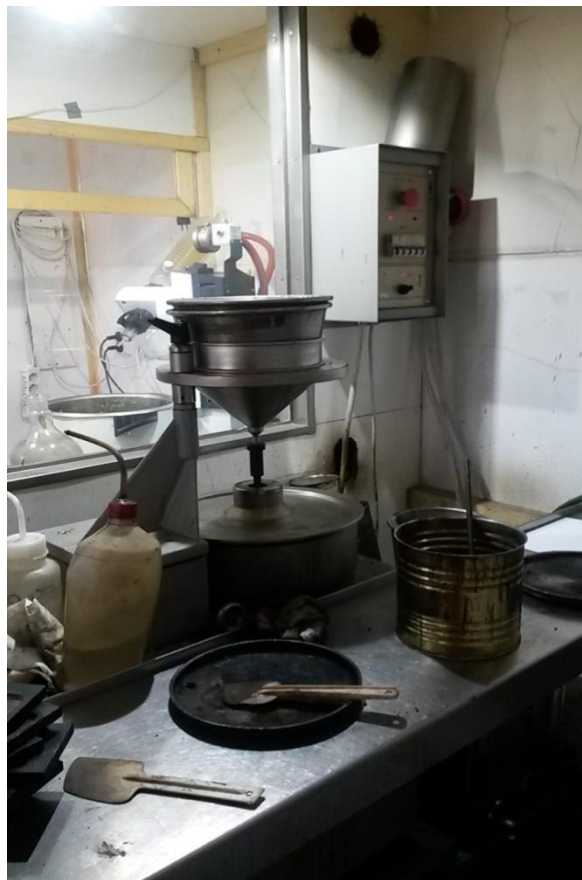
Obrázok č. 37: Prietoková laboratórna odstredivka pre oddelenie kameniva [35]
