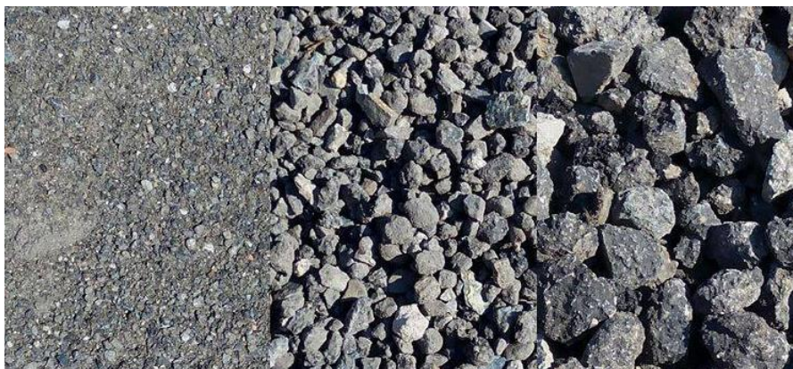
Obrázok č. 8: R-materiál (asfaltový recyklát) frakcii 0/8, 8/32, 32/64 mm [9]
