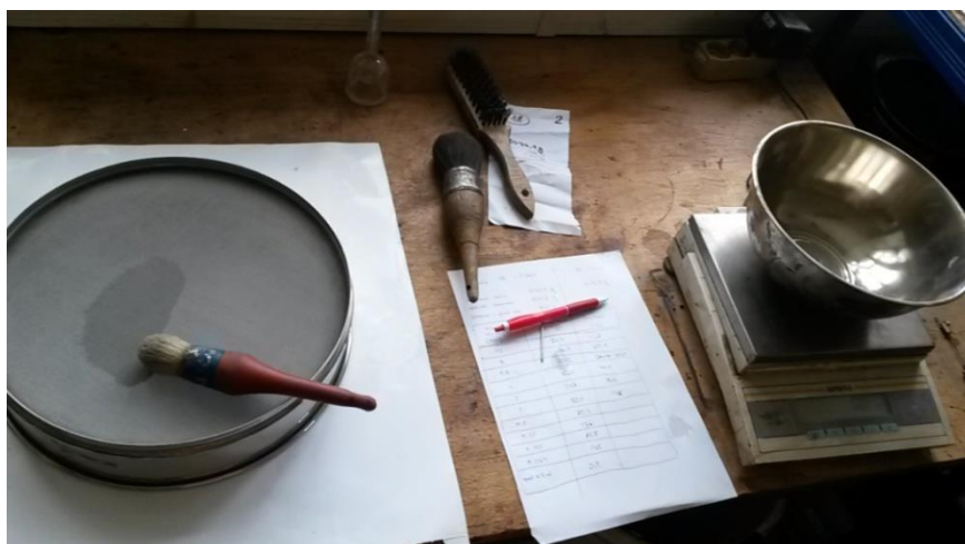
Obrázok č. 42: Váženie zostatku na jednotlivých sitách
