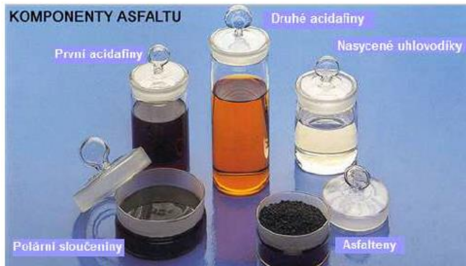
Obrázok č. 21: Komponenty asfaltu [17]
