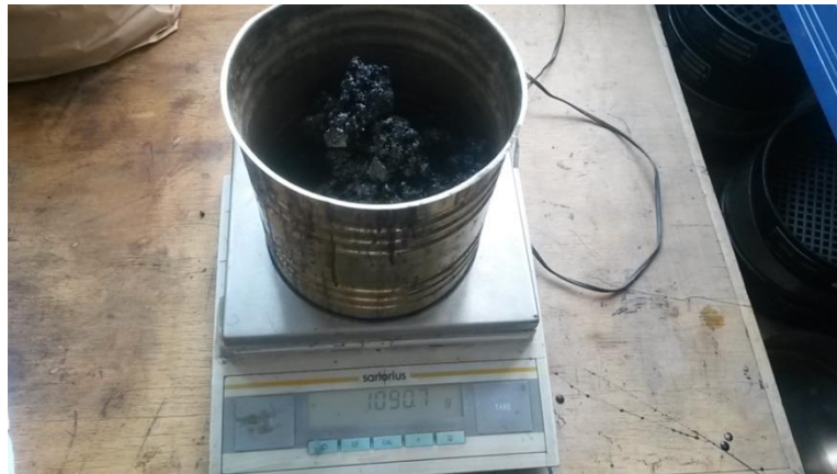
Obrázok č. 35: Váženie jednotlivých vzoriek R-materiálu
