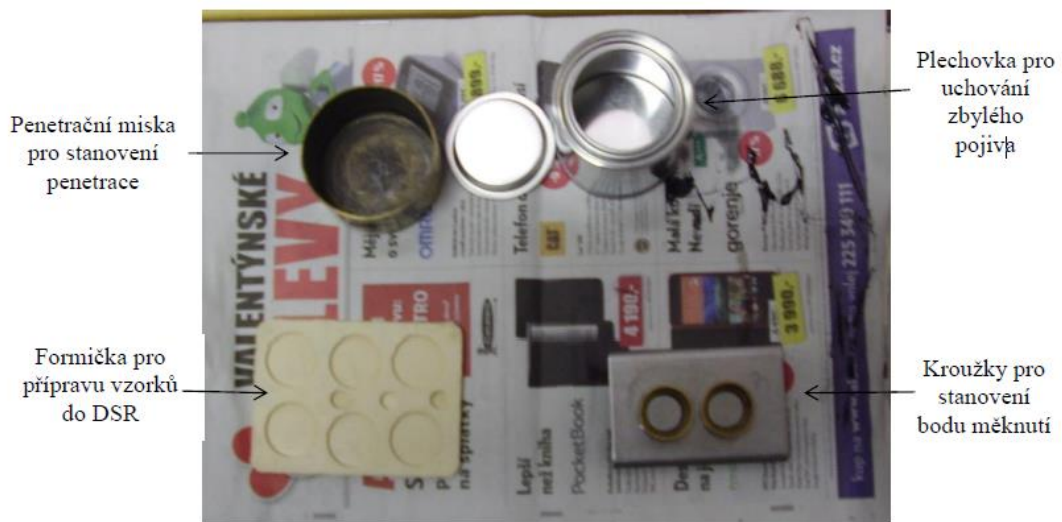
Obrázok č. 38: Skúšobné formy a misky [3]
