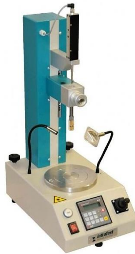
Obrázok č. 44: Príklad penetrometru [40]
