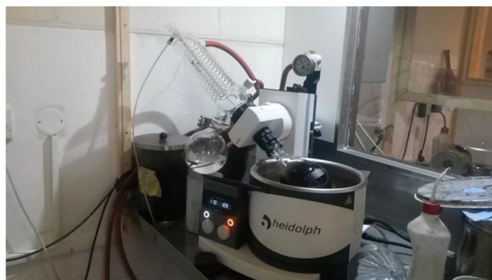
Obrázok č. 39: Rotačné vákuové destilačné zariadenie
