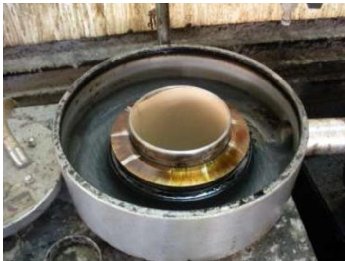
Obrázok č. 36: Umiestnenie patróny s filtračným papierom [35]
