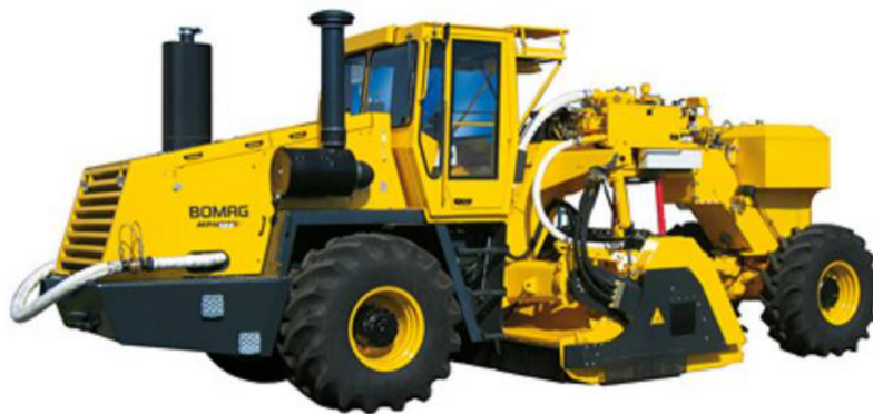
Obrázok č. 2: Recyklačná fréza Bomag [6]
