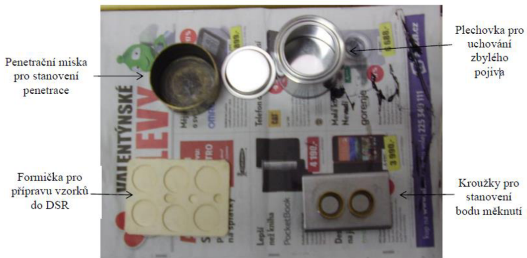
Obrázok č. 38: Skúšobné formy a misky [3]
