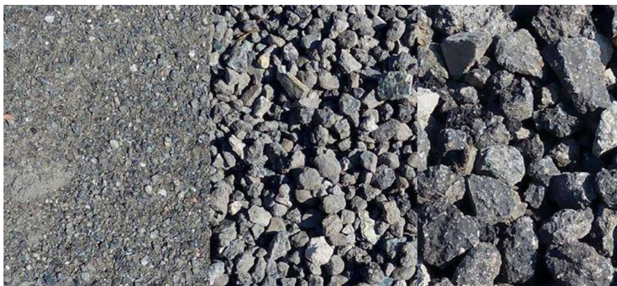
Obrázok č. 8: R-materiál (asfaltový recyklát) frakcii 0/8, 8/32, 32/64 mm [9]
