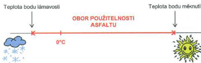
Obrázok č. 26: Obor použiteľnosti asfaltových spojív [5]
