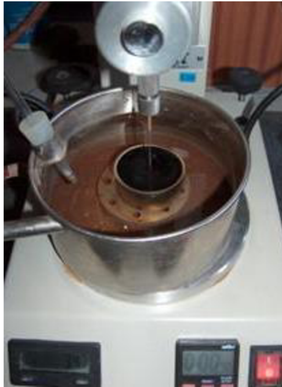
Obrázok č. 46: Penetrácia ihlou do vytemperovaného vzorku [41]
