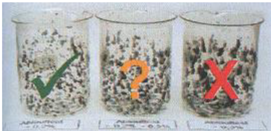
Obrázok č. 31: Skúška stekavosti pre rôzne dávkovanie celulóзовých vlákien [5]
