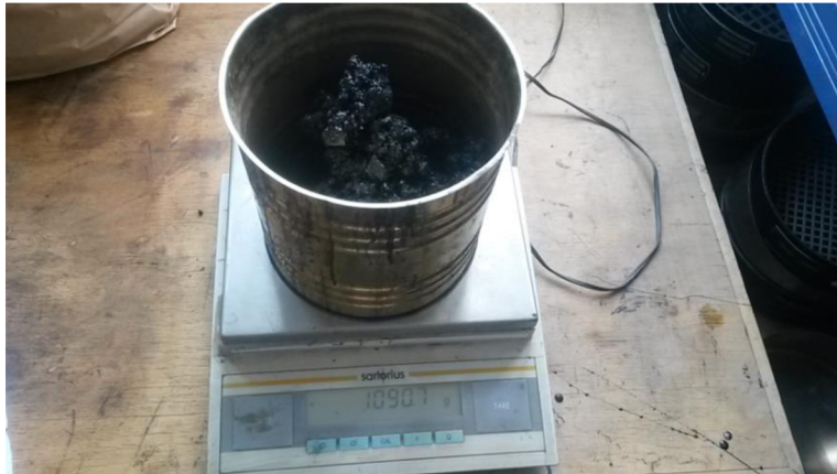
Obrázok č. 35: Váženie jednotlivých vzoriek R-materiálu
