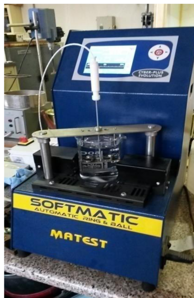
Obrázok č. 48: Prístroj pre skúšku stanovenie bodu mäknutia metódou KK
