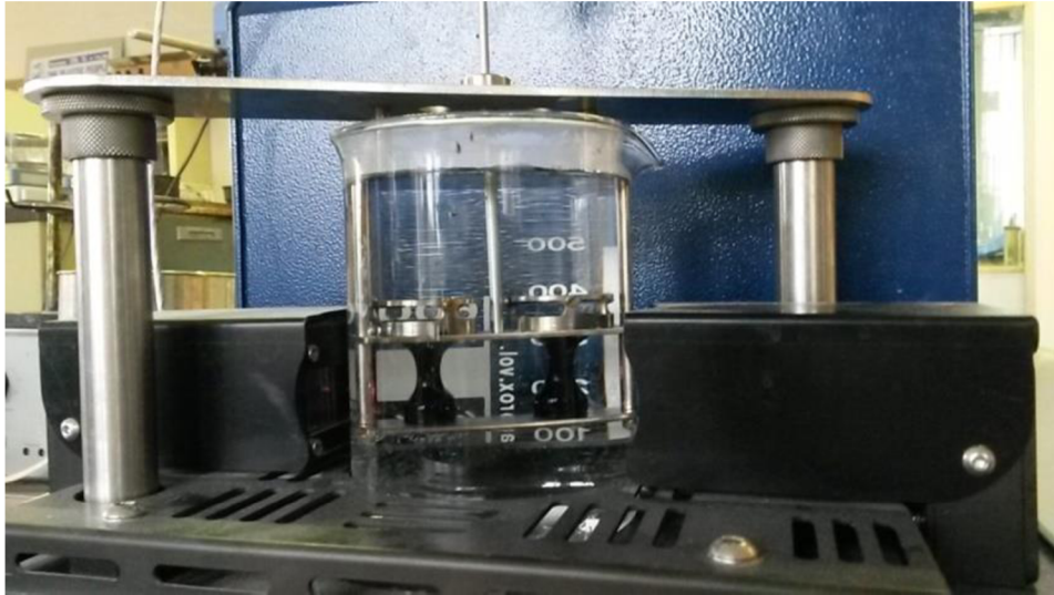
Obrázok č. 49: Prepad guľôčok asfaltovým spojivom
