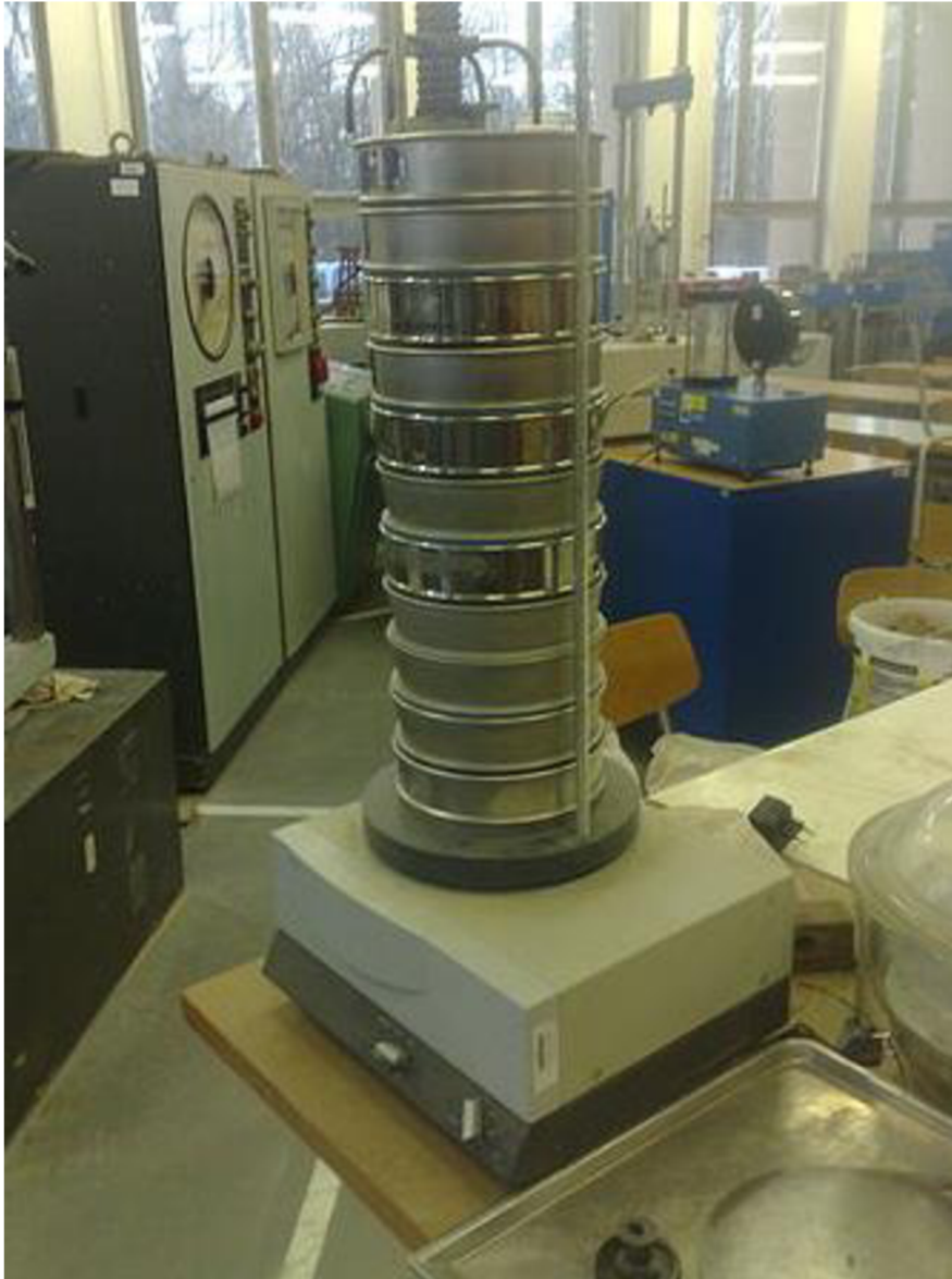
Obrázok č. 41: Prístroj na vibračné preosievanie kameniva [37]
