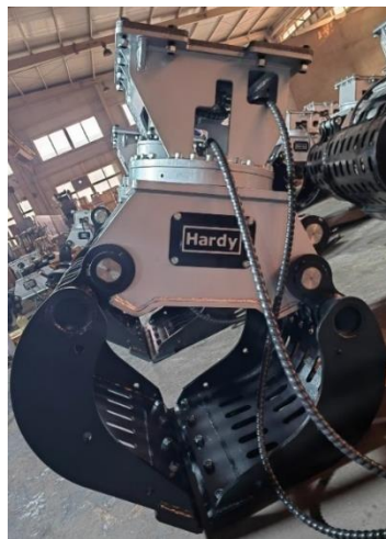
Obrázek 3 Demoliční třídící drapák Hardy
