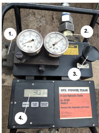
Obrázek 14 Měření průtoku hydraulické kapaliny zařízením SPX Power Team HT200 Model C
