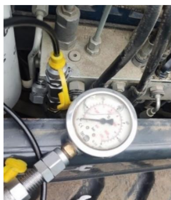
Obrázek 16 Měření tlaku hydraulické kapaliny na rypadlu Bobcat
