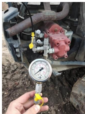
Obrázek 15 Měření tlaku hydraulické kapaliny na rypadlu Kubota
