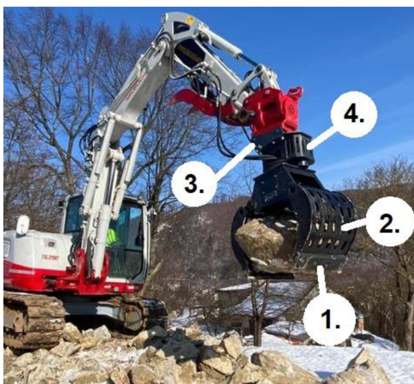
Obrázek 1 Konstrukce drapáku Hardy RDG 04
