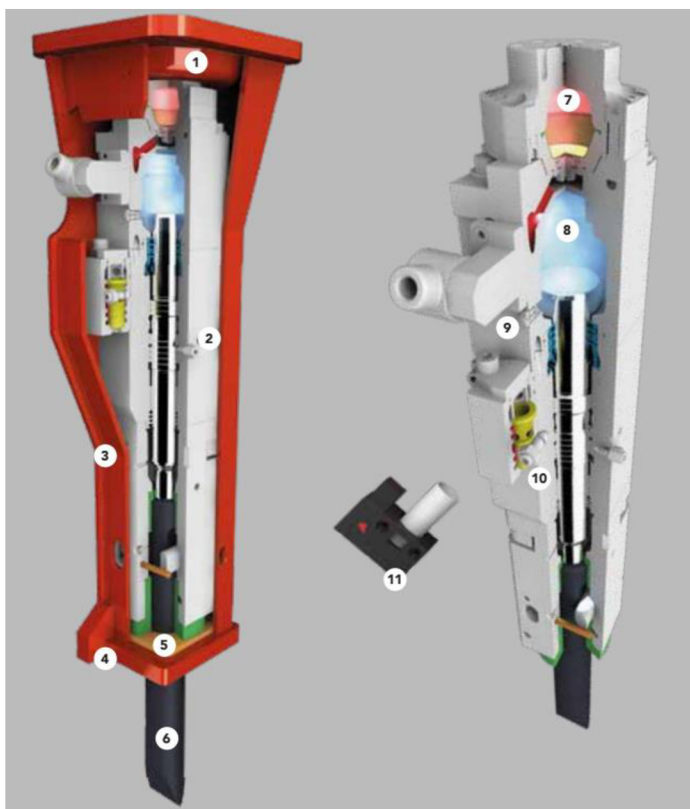
Obrázek 5 Konstrukce hydraulického kladiva
