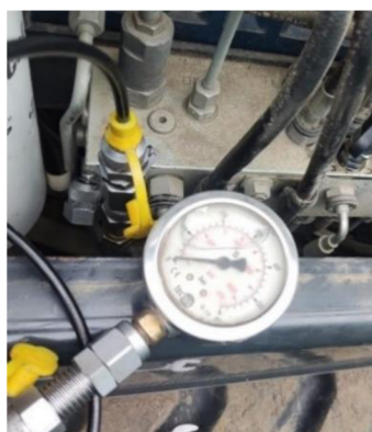
Obrázek 16 Měření tlaku hydraulické kapaliny na rypadlu Bobcat
