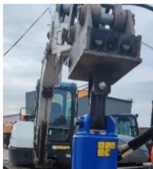
Obrázek 19 Bobcat E35Z a Obrázek 18 Hodnota otáček motoru rychloupínací adaptér Lehnhoff MS03 Bobcat E35Z
