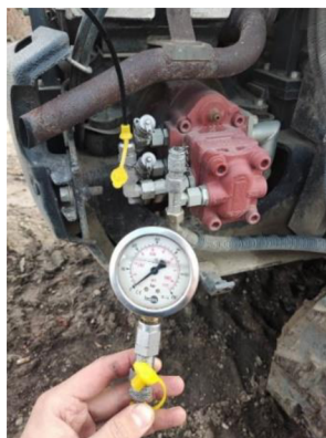
Obrázek 15 Měření tlaku hydraulické kapaliny na rypadlu Kubota
