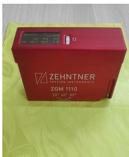
Obrázek 12: Hodnocení leskoměrem ZEHTNER
