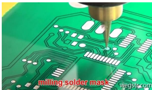
Obrázek 5 Frézování nepájivé masky Zdroj: https://www.youtube.com/watch?v=7EctuSTL7-w
