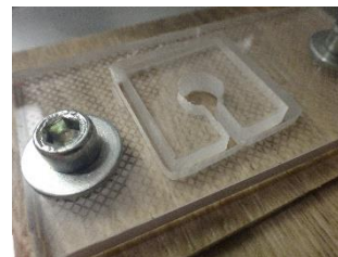
Obrázek 19 Vyfrézovaná část držáku, zdroj: vlastní
