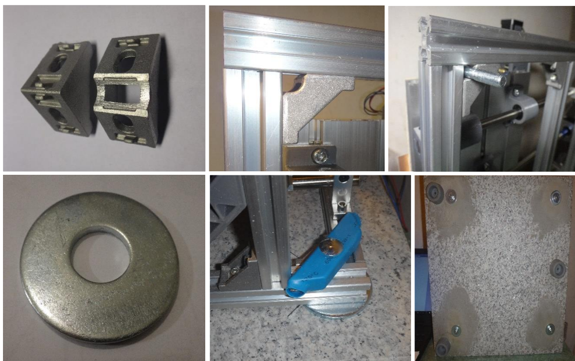
Obrázek 26 Příprava rámu frézky pro montáž a montáž na granitovou desku Zdroj: vlastní
