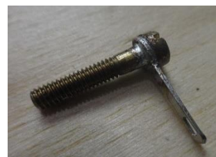
Obrázek 20 Šroub sondy s pájecím očkem, zdroj: vlastní
