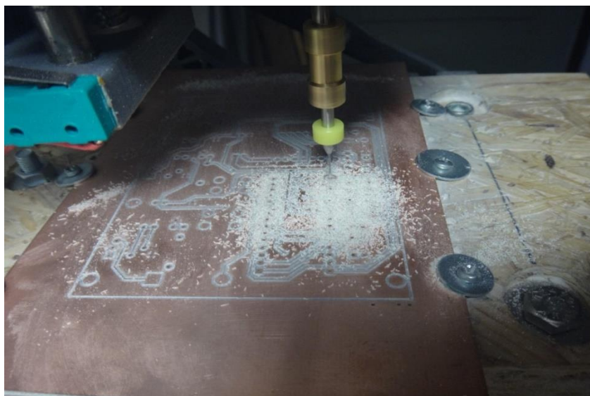
Obrázek 47 Vrtání DPS Zdroj: vlastní
