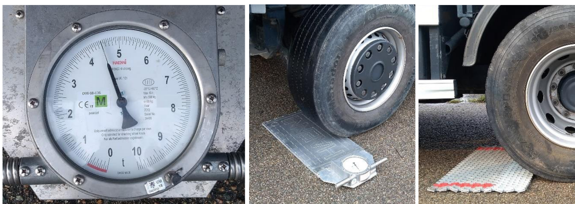
Obr. č. 25 - Přenosná váha Haenni WL 101 a příprava na vážení vozidla (Zdroj: Vlastní)
