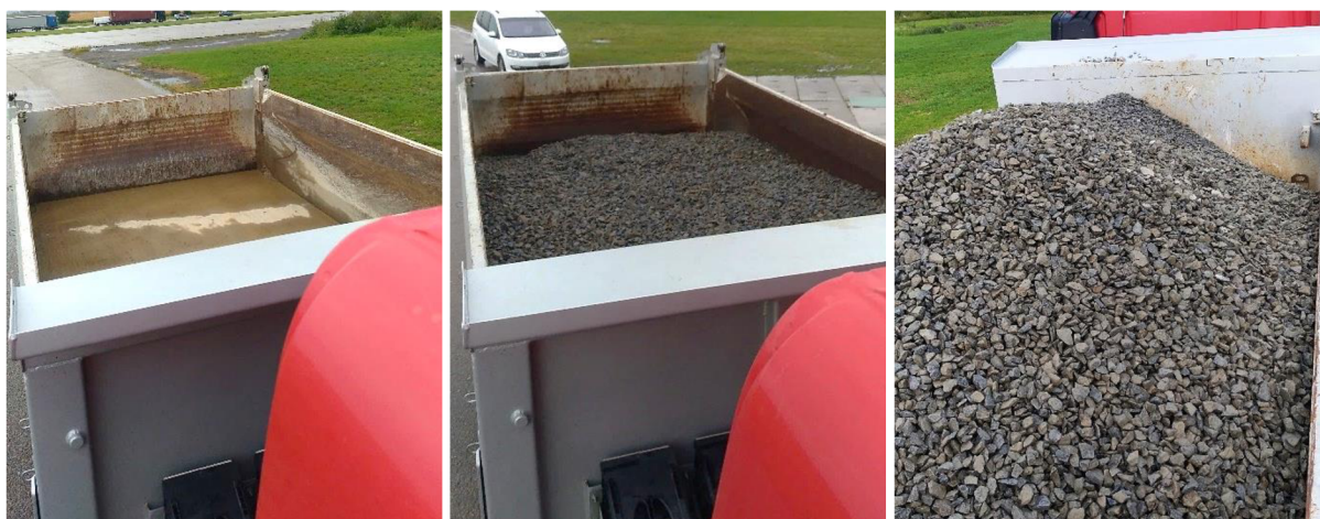
Obr. č. 30 - Zleva: prázdné, částečně zatížené a přetížené vozidlo Tatra (Zdroj: Vlastní)
