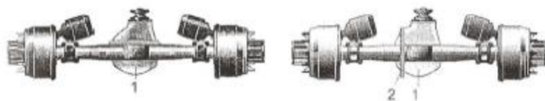
Obr. č. 4 - Vlevo: nedělená tuhá hnací náprava "banjo"; vpravo: dělená tuhá hnací náprava (Zdroj: Převezato z (Vlk, 2003, s. 145))
