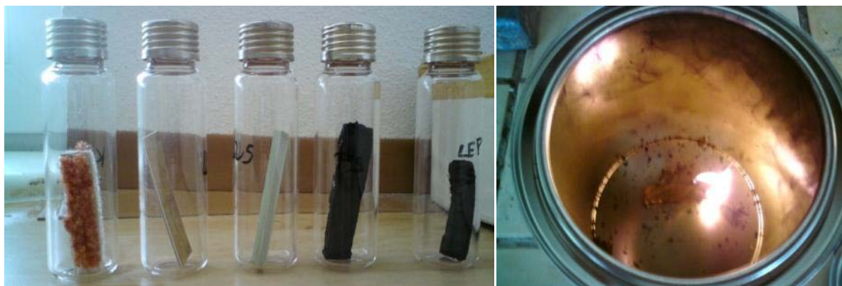
Obr. 34: Použité vzorky matric (zleva: koberec, PVC, linoleum, pneu, lepenka) a ukázka jejich pálení
