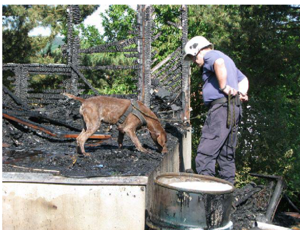
Obr. 8: Využití psa při zjišťování přítomnosti hořlavých kapalin jako akcelerantu hoření [7]
