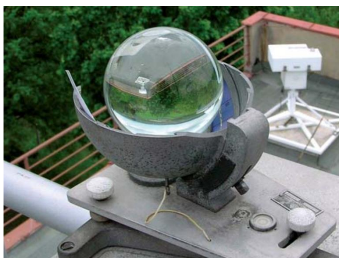
Obrázek 16: Campbell-Stokesův slunoměr – heliograf (Pokorný & Vaníček 2007)
