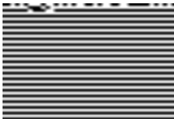
Obrázek 4.19: Bitmapový obrázek který vykresluje průběh transformace celulárního automatu v jednom z pokusů se šířkou CA s = 40 , který našel takovou transformační funkci, která vedla pro daný iniciační stav k synchronizaci. černé body reprezentují binární hodnotu 0 a bílé 1.
