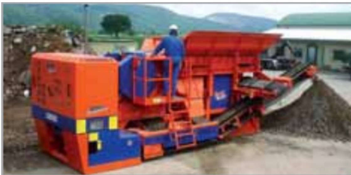
Obr. 4.3 Drtiče dvouvzpěrné čelistové DCD
