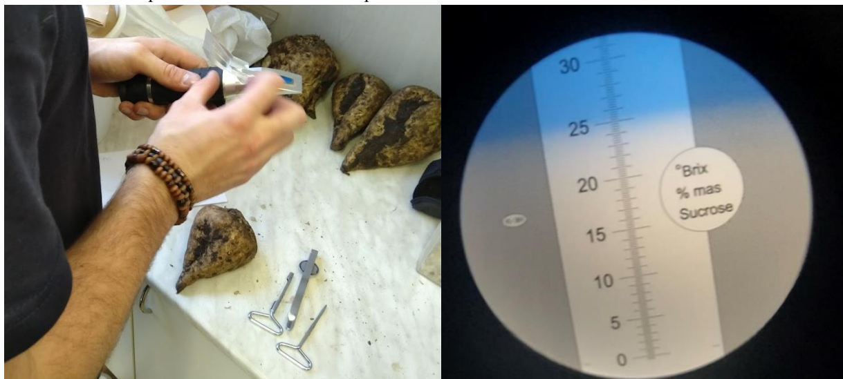
Obr. 13. Stanovení průměrné cukernatosti bulev pomocí refraktometru.
