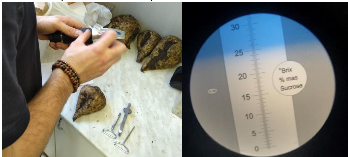
Obr. 13. Stanovení průměrné cukernatosti bulev pomocí refraktometru.
