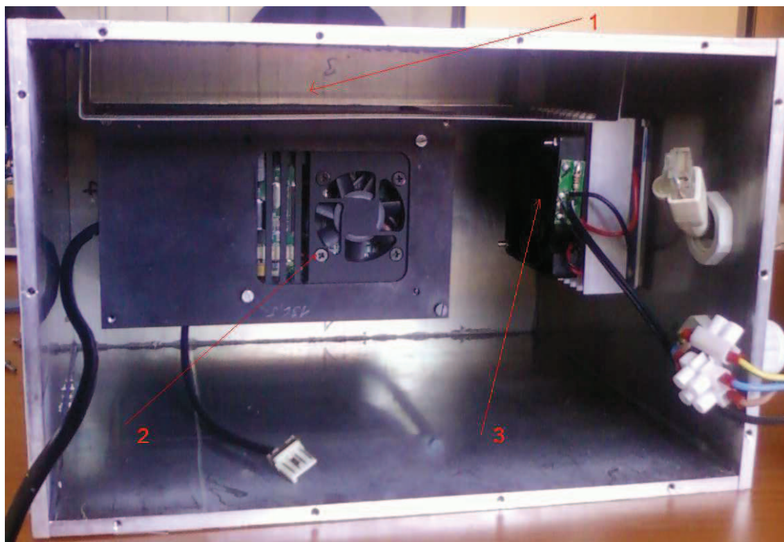
Obrázek 6.5: Tělo kamery. 1 - prostor pro řídicí počítač, 2 - kamera, 3 - Peltierův článek na chlazení a ohřev (v zimním období)
