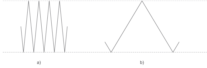
Obrázek 4.5: Ukázka dvou povrchů se stejným R_a a R_q
