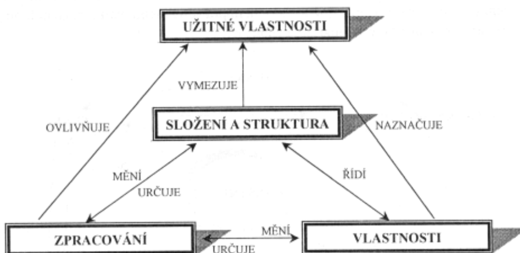
Obr. 2.2 Vztah mezi složením a strukturou materiálu, jeho zpracováním, vlastnostmi a užitnými vlastnostmi výrobku (8) .
