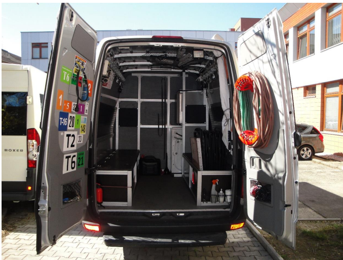
Příloha č. 9: Nákladový prostor upravený pro přepravu kol
