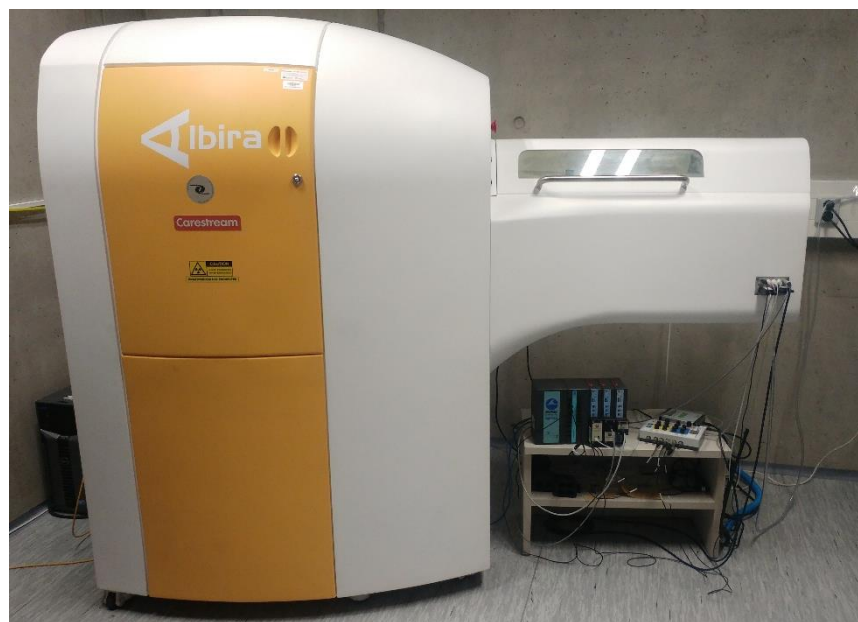
Obr. 19. Příklad přístroje Albira pro PET/SPECT/CT zobrazování laboratorních zvířat. V pravé části je umístěno lůžko pro laboratorní zvířata, které je při měření zasunuto do levé části, kde probíhá měření. Fotograf:
