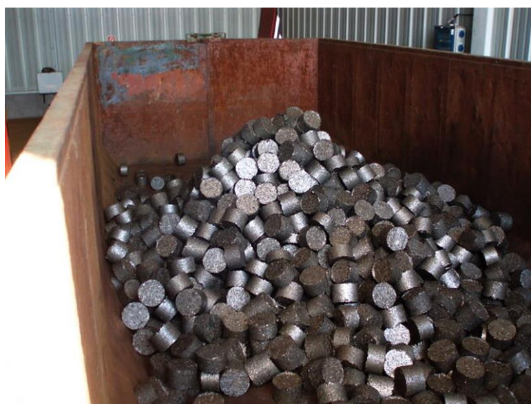
Obrázek č. 10: Brikety ze špon ve firmě UNEX a. s. (pobočka Olomouc), 17. 11. 2015. Foto: Mgr. Roman Slaviček
