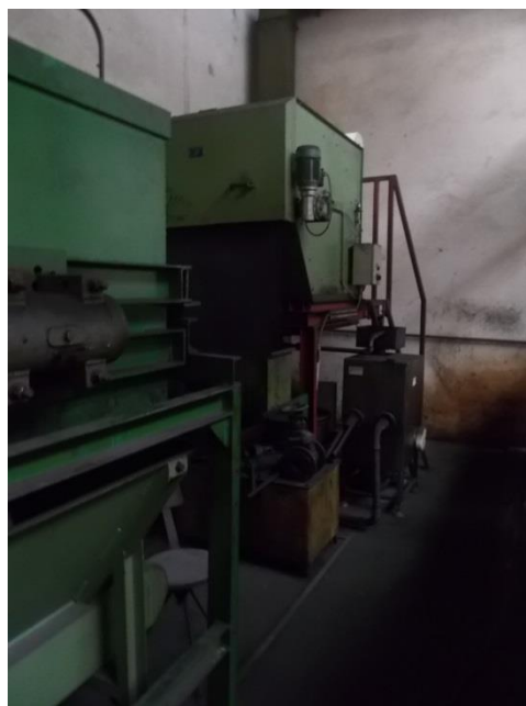
Obrázek č. 7: Násypka s odmašťovadlem pro železné špony ve firmě UNEX a. s. (pobočka Olomouc), 17. 11. 2015. Foto: Mgr. Roman Slaviček
