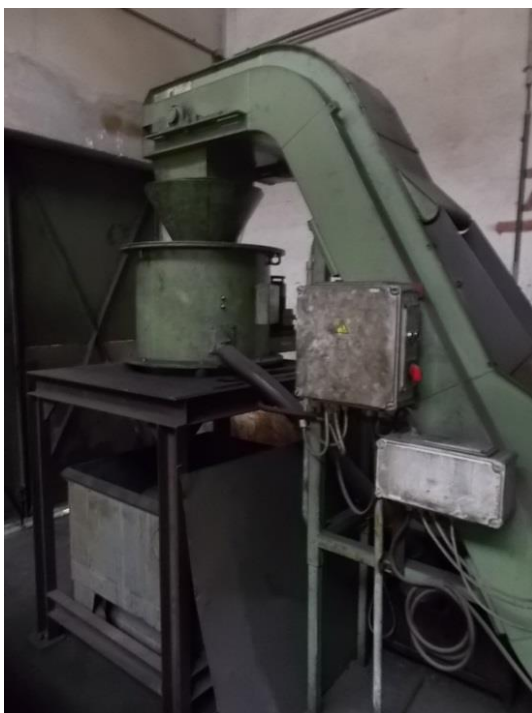
Obrázek č. 9: Lis na vyčištěné špony ve firmě UNEX a. s. (pobočka Olomouc), 17. 11. 2015. Foto: Mgr. Roman Slaviček
