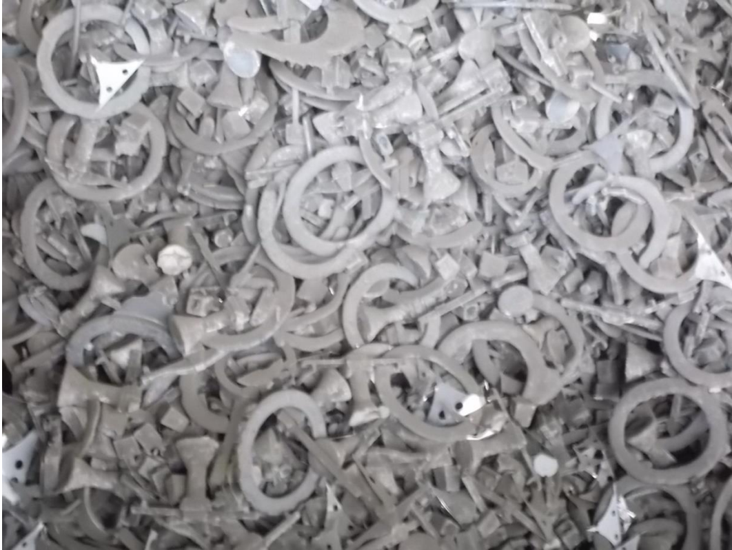
Obrázek č. 4: Části vtoků, nálitky a zmetkové odlitky tvořící odpad z provozu slévárna v UNEX a. s. (pobočka Olomouc), 17. 11. 2015. Foto: Mgr. Roman Slaviček
