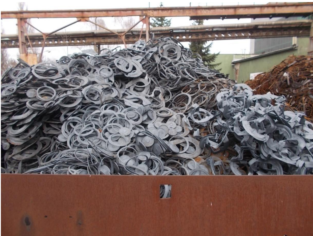
Obrázek č. 3: Výstřížky a průstřížky tvořící odpad z provozu kovárna v UNEX a. s. (pobočka Olomouc), 17. 11. 2015. Foto: Mgr. Roman Slaviček
