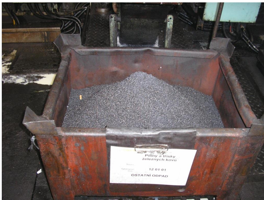
Obrázek č. 5: Špony z litiny z provozu obrobna ve firmě UNEX a. s. (pobočka Olomouc), 17. 11. 2015. Foto: Mgr. Roman Slaviček
