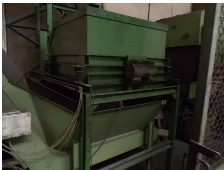
Obrázek č. 8: Separáčn část a sušička ve firmě UNEX a. s. (pobočka Olomouc), 17. 11. 2015. Foto: Mgr. Roman Slaviček
