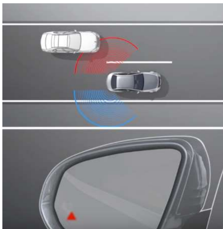
Obrázek 7 - Ukázka principu funkce BSI (41)
