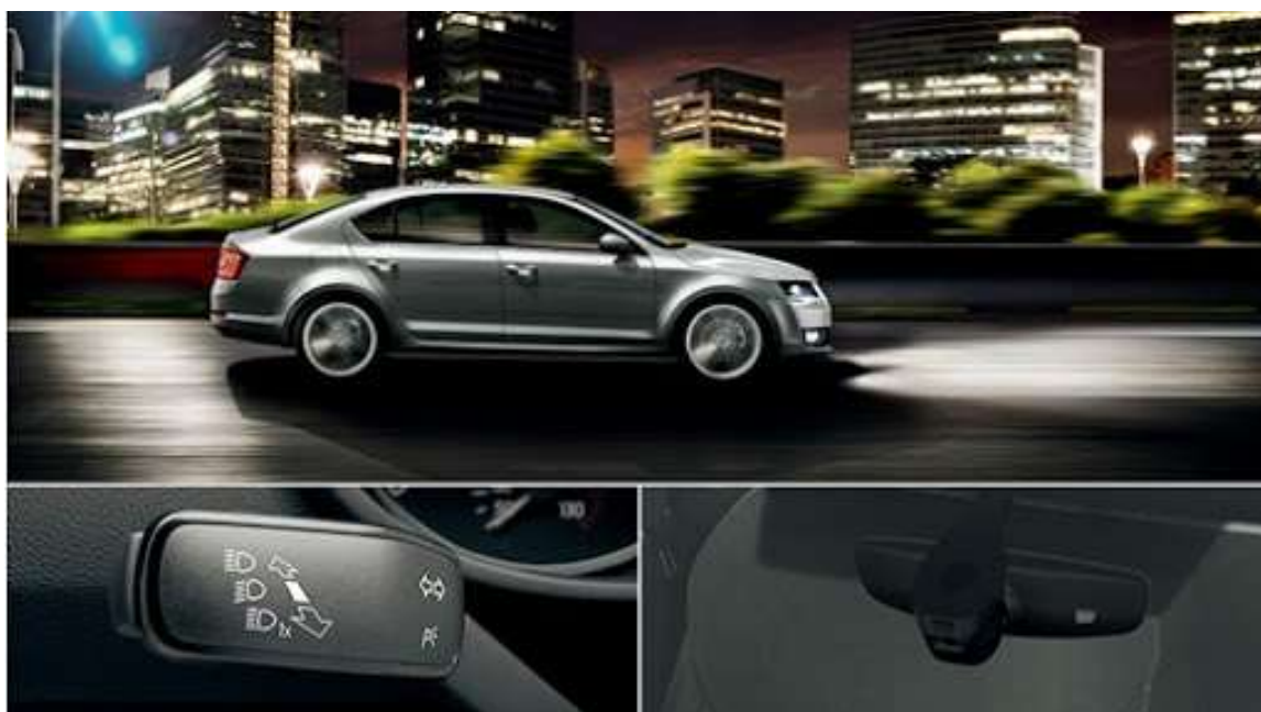
Obrázek 8 - Umístění kamery FLA a značení na páčce u volantu (18)
