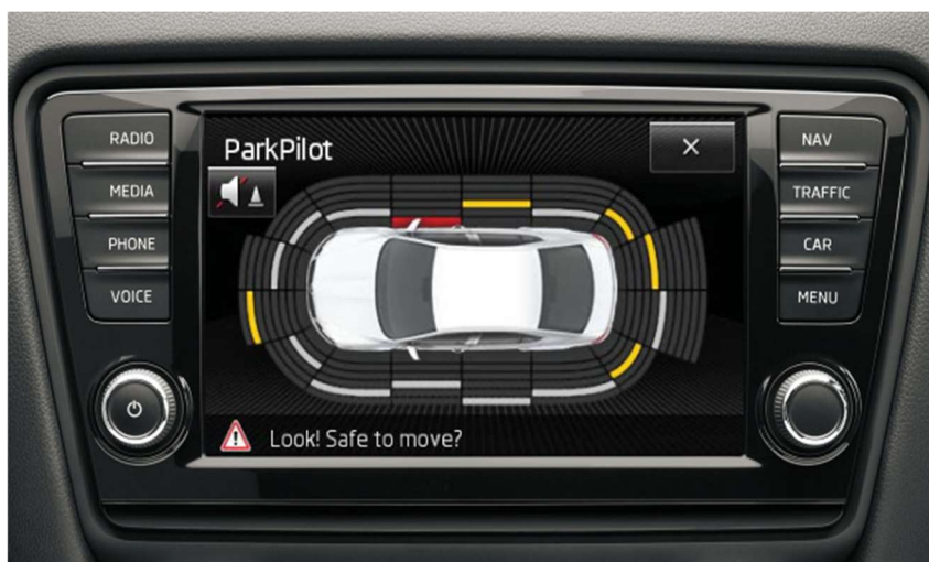
Obrázek 11 - LED displej s ukázkou funkce pas. parkovacího asistenta (44)
