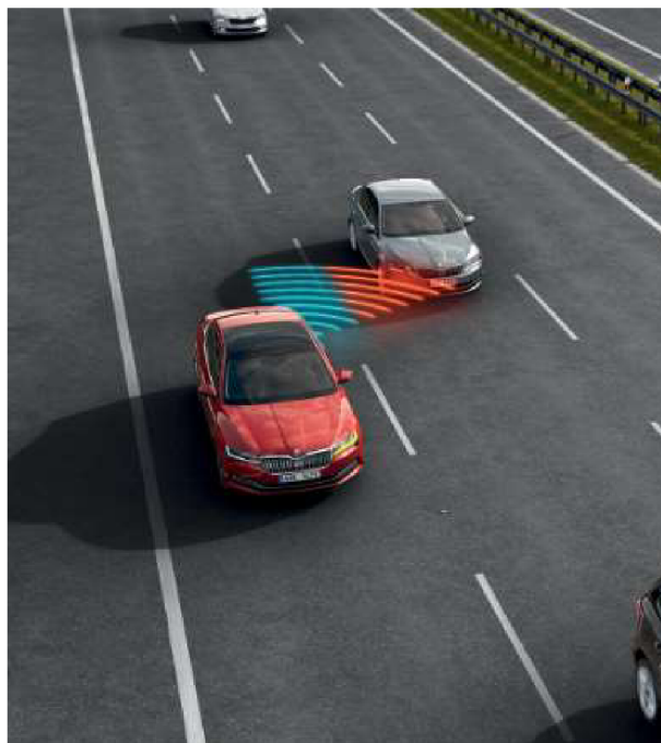
Obrázek 6 - Princip funkce LDW (40)
