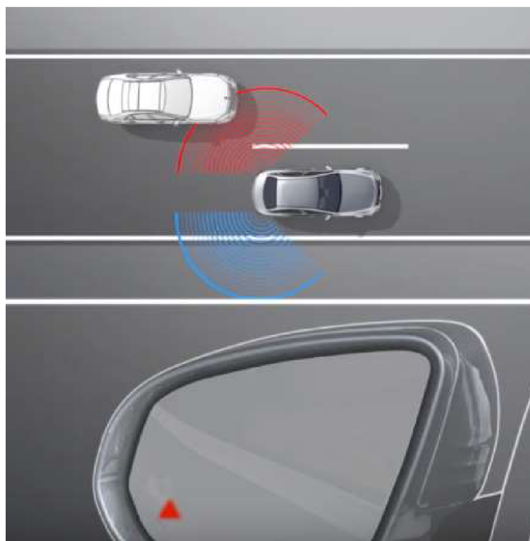
Obrázek 7 - Ukázka principu funkce BSI (41)
