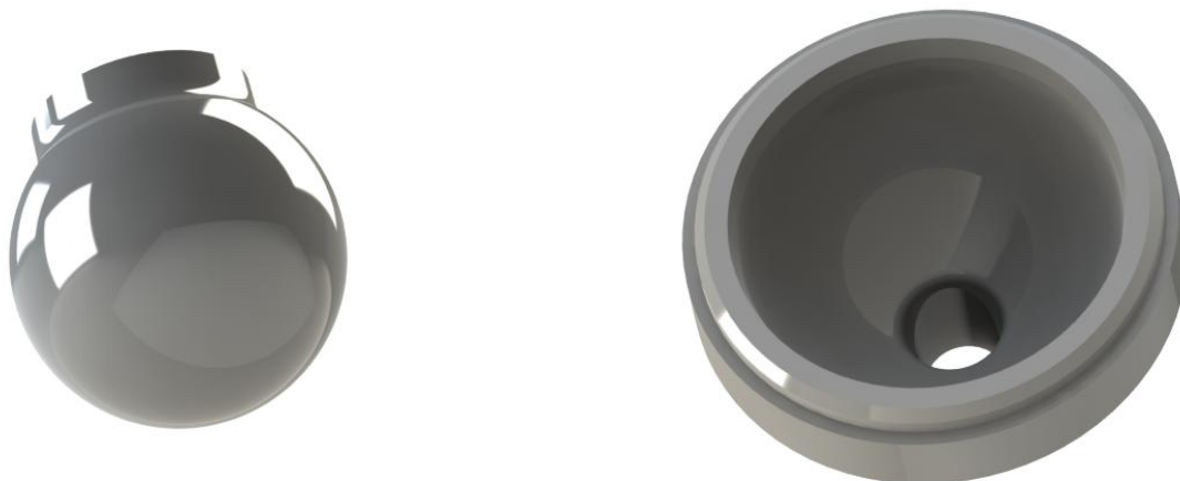
Obr. 9.1: Zjednodušený model geometrie hlavice a jamky
