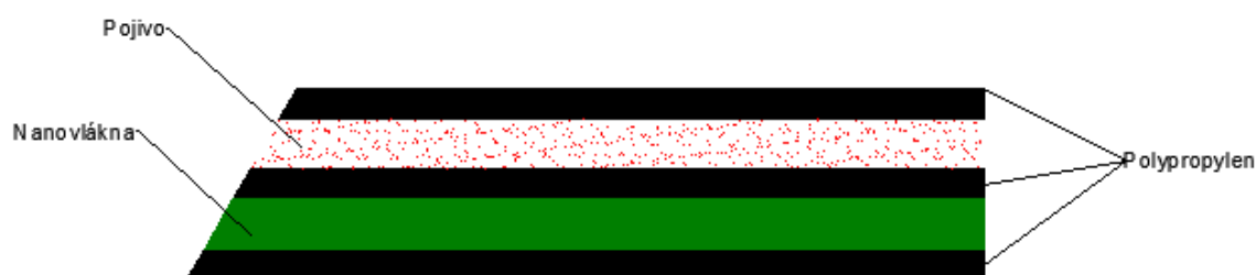
Obr. 5 – Složení filtrační vložky
