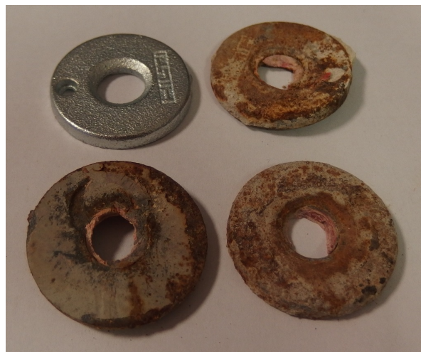
Obr. 5.75 Porovnání nové a zkorodovaných sférických podložek z HILTI dynamického setu
