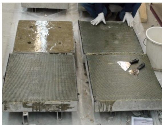
Obr. 2.58 Pohled na vzorky při aplikaci jednovrstvého laminátu [53]
