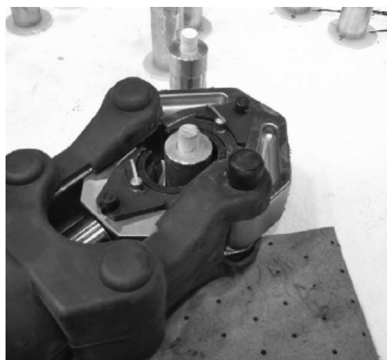
Obr. 2.40 Kotevní prvek na GFRP výztuž osazován pomocí hydraulických kleští [43]
