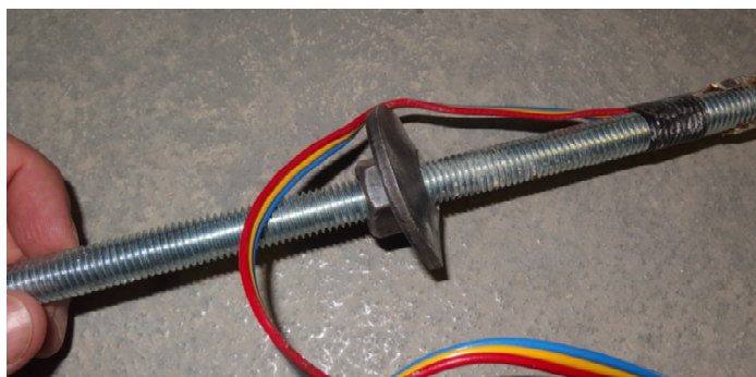
Obr. 5.67 Deformace podložky Ø44/4 mm po aktivaci závitové tyče
