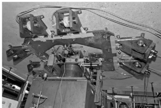
Obr. 2.62 Pohled na spodní povrch desky s kotevními prvky pro CFRP [61]
