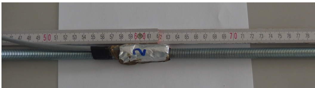
Obr. 5.65 Umístění odporového tenzometru na závitové tyči před osazením do vrtu
