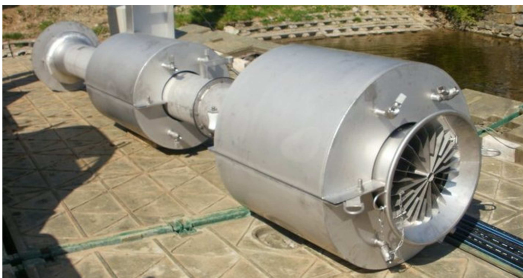
Obr. 3.2.4 Aerační věž s čerpadlem.[37]
